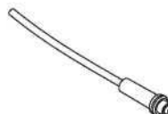
13) Zajišťovací svorka: příslušenství zajišťující zásuvné připojení hadiček do fitinek před neúmyslným odpojením na snadno přístupných místech. Zajišťovací svorka nemá vliv na těsnost spojení. Počet zajišťovacích svorek ve Vašem filtru reverzní osmózy závisí na typu výrobku a nemá žádný vliv na jeho výkon.
