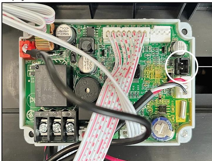
Miesto pripojenia spojovacieho kábla k riadiacej hlave
